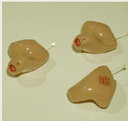
▲ Schon erfolgreich auf dem Markt: Im-Ohr-Hörgeräte von Audio-Service, mit einer keimtötenden und Schmutz abweisenden Oberfläche
