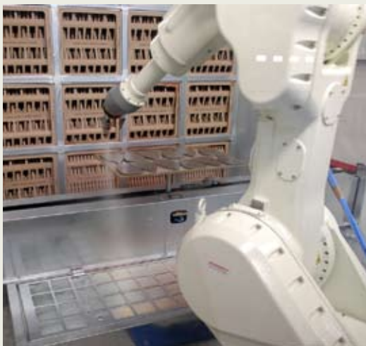
▲ Computergesteuerte Nassbeschichtung durch Industrieroboter für ultradünne Schichten
