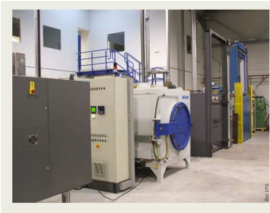
▲ Wichtiger Zukunftsmarkt: Über Jahre kratzfeste, keimtötende und selbstreinigende Oberflächen für Kliniken und andere Bereiche ◀ Die Beschichtungen werden in Hochtemperaturöfen verdichtet
