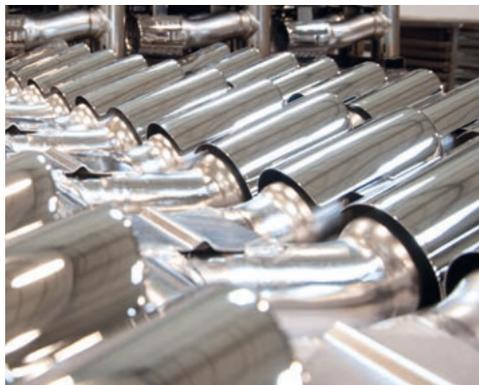
Transparente Nanoseal-Beschichtung auf hochglanzpolierten Edelstahl-Endrohrblenden
