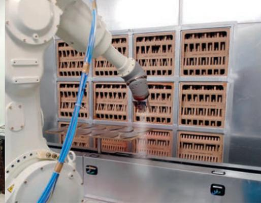
Beschichtungstechnologie für die Serienproduktion
